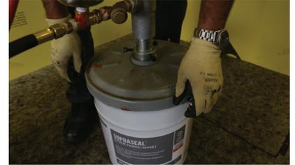
Brancher la pompe au compresseur d'air, la pompe démarrera alors automatiquement. Ajuster la pression d'air à 60 psi sur le régulateur de droite. Le régulateur de gauche indique la pression d'air disponible pour le pistolet.
